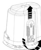
Разблокировать двигатель (повернуть ключ против часовой стрелки до концевика без приложения усилия) и передвинуть ворота вручную.
