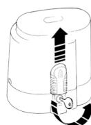
Разблокировать двигатель (повернуть ключ против часовой стрелки до концевика без приложения усилия) и передвинуть ворота вручную.
