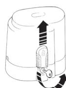
Разблокировать двигатель (поворнуть ключ против часовой стрелки до концевика без приложения усилия) и передвинуть ворота вручную.
